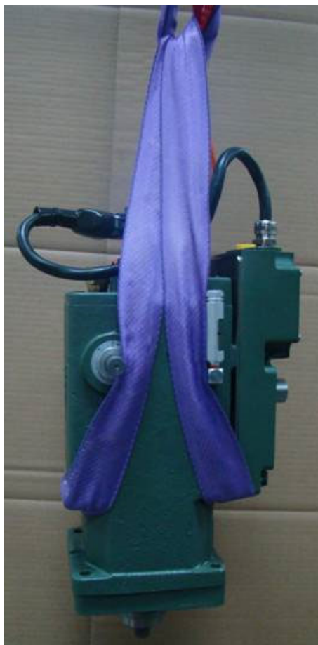
図 2-3. 適切な吊り上げ方法
