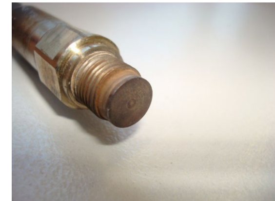
10.000 h 使用後の先端状態 クリーン
